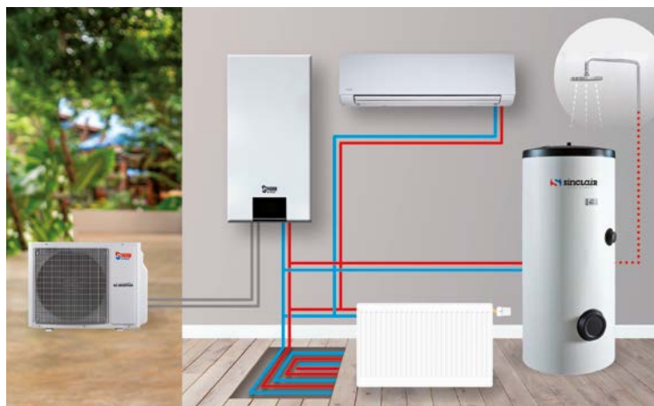
RISCALDAMENTO / RAFFRESCAMENTO A PAVIMENTO E RADIATORI + VENTILCONVETTORI
