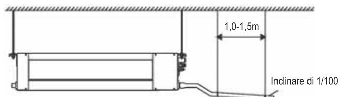
Per le unità dotate di pompa di scarico
