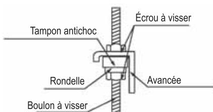
2.3.3 Vissez les écrous pour suspendre l'appareil
