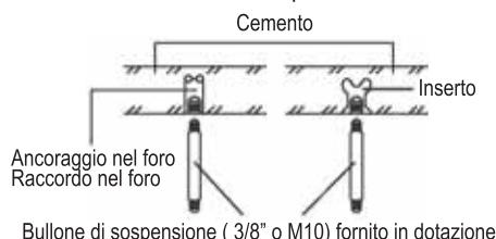
2.2.3 Installare i bulloni di sospensione (utilizzare bulloni di sospensione W3/8 o M10, 4 pezzi) in base alla tipologia di soffitto.
