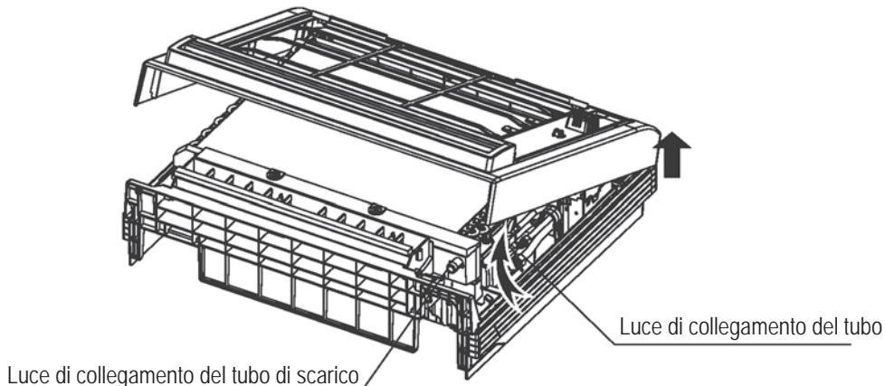
2.3.4 Rimuovere il supporto di installazione ed estrarre il coperchio della scatola comandi. Prestare attenzione a non danneggiare i terminali del cablaggio.
