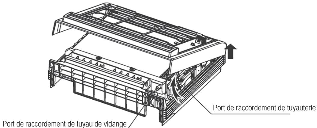
2.3.4 Retirez le support d'installation, puis enlevez le couvercle de la boîte de commande. La terminaison du câblage est visible.
