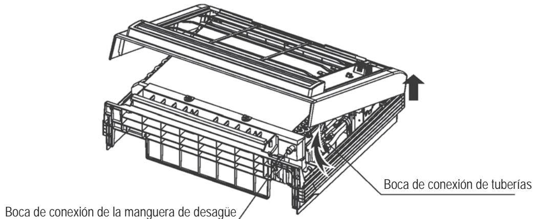
2.3.4 Extraiga el soporte de instalación y saque la cubierta de la caja de control. Podrá observar el terminador de cables.
