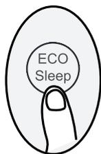
La temperatura impostata aumenterà (raffreddamento) o diminuirà (riscaldamento) di 1 °C all'ora per le prime 2 ore. Fare riferimento al MANUALE DEL PROPRIETARIO per maggiori dettagli.
