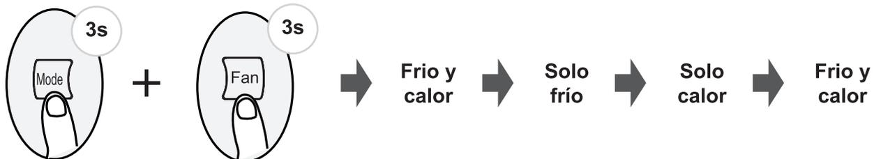
Para el mando a distancia de frío y calor: Se pueden seleccionar los modos Auto, Frío, Seco, Calor y Ventilador.
