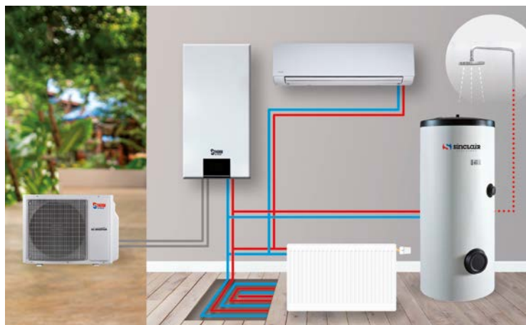
RISCALDAMENTO / RAFFRESCAMENTO A PAVIMENTO E RADIATORI + VENTILCONVETTORI
