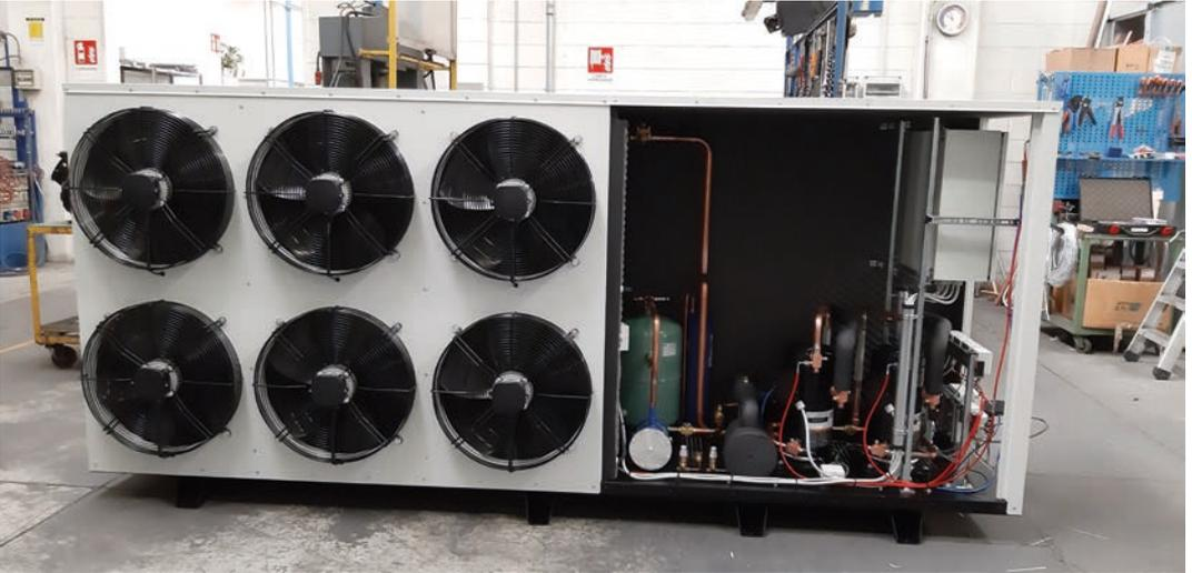
Unità carenata silenziosa con capacità 50kW, è dotata di 2 compressori scroll con gas R449, quadro elettrico speciale e 6 ventilatori da 500 mm
