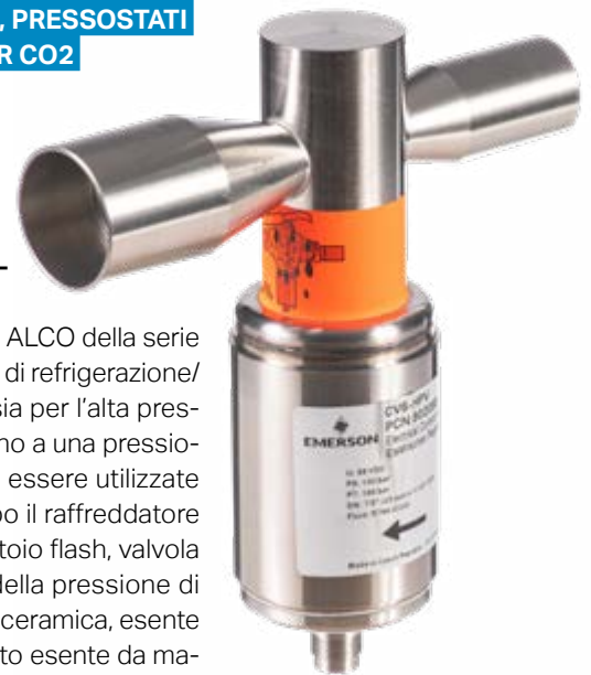
Valvola con motore passo-passo ALCO CV6 per gli impianti di refrigerazione/ climatizzazione a CO2 transcritici
