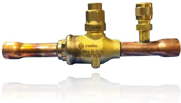
Le valvole a sfera RBV-45 sono bi-direzionali, complete di foro (di pressione) e adatte per le applicazioni HFC/HFO. Possono essere utilizzate su linee del liquido, di aspirazione e di gas caldo negli impianti di refrigerazione e di condizionamento dell'aria e possono essere completamente aperte o chiuse con un solo ¼ di giro dello stelo della valvola.
